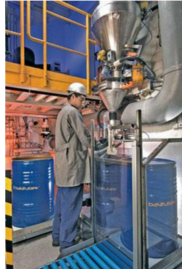
Geschlossene und staubfreie CNT-Abfüllstation
